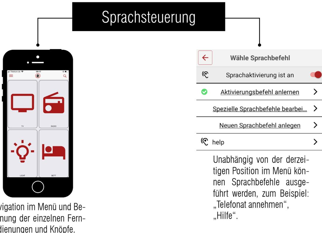
Um die Sprachsteuerung nutzen zu können müssen Sie einen Aktivierungsbefehl über Sprachbeispiele antrainieren. Das mitgelieferte USB Mikrofon startet mit diesem Aktivierungsbefehl die Spracheingabe und die App hört nun mit. Für den eigentlichen Spracheingabebefehl verwenden wir das Mikrofon des Smartphones oder Tablets.
